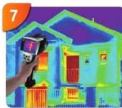
단열측정 건물 단열성능 파악
